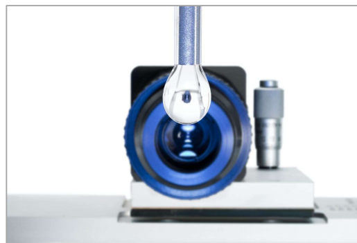
Visión de la gota colgante en la determinación de Tensión superficial
