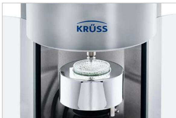
Porta muestra con control de temperatura integrado
